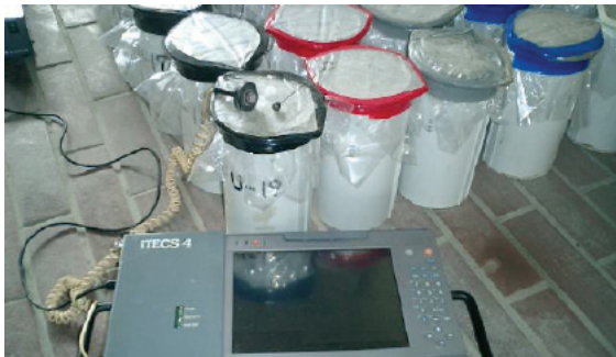
養生方法状況例：プラスチック製モールド (左)，軽量モールド (右)
